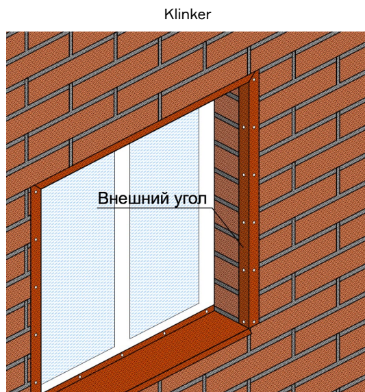
Рис. 30. Обрамление оконного проёма при помощи внешнего угла с посыпкой (тип 2, таблица №2).
